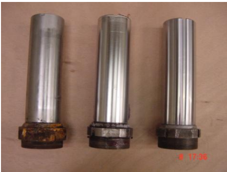
Pièce avant / après chromage / après rectification finale
