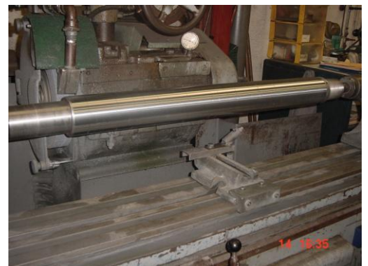
Tige de vérin sur rectifieuse
